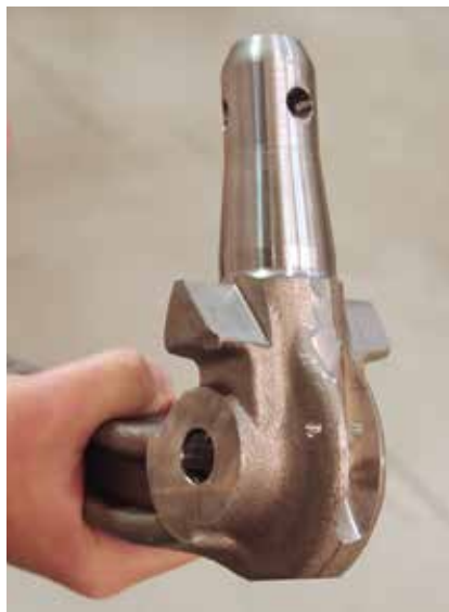
5 Rundum und unter Winkeln radial und axial präzise zu bearbeiten: Der kegelförmige »Turm« sorgt für eine stabile und sichere Verbindung der Anhängerkupplung mit dem Fahrzeug (Bild: Mücke)
