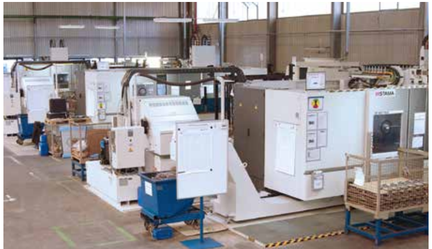
3 Schaffen Freiräume: Mit ihrer hochproduktiven Komplettbearbeitung ersetzen vertikale, fünfachsige Fräs-Drehzentren MT 837 Twin von Stama bei Westfalia-Automotive eine Vielzahl unterschiedlicher Fräs- und Drehzentren (Bild: Mücke)
